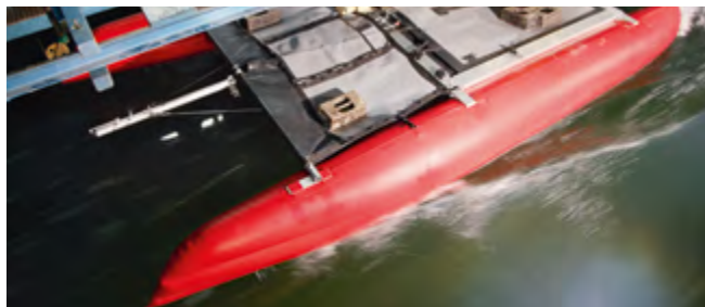
Schlepptankversuche in der Schiffsbau-technischen Versuchsanstalt
